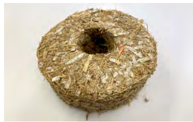
図1 ジャイアントミスカンサスとシュレッターの紙で作ったプリケット
